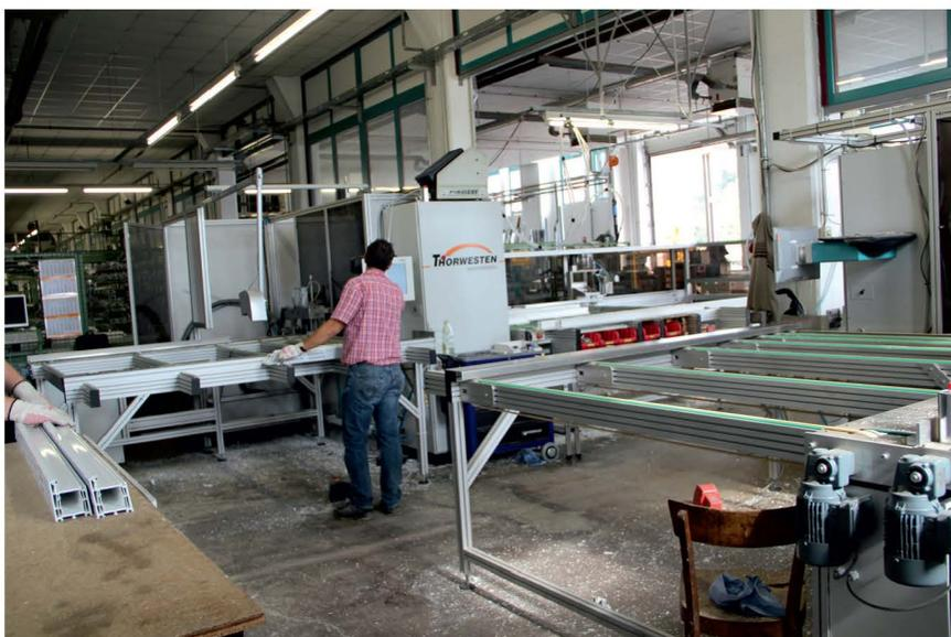
Allein in 2011 und 2012 wurden 1 Mio. Euro investiert. 2011 wurden zwei neue Stabbearbeitungszentren von Thorwesten in die Fertigung integriert. Damit erhöhte sich die Fertigungskapazität auf 200 Fenstereinheiten pro Schicht.
