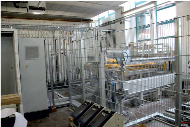
*Die automatische Flügelbeschlagslinie ist die jüngste Investition in Zorge und wurde jetzt im August in Betrieb genommen. Im Vordergrund rechts der Achsen-schrauber, dahinter das Regallager.*
