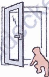
Wo Kleinkinder oder Personen mit geistiger Behinderung Zugang zum Fenster haben, ist der Flügel gegen Aufdrehen zu sichern, z. B. mit Dreh Sperre oder abschließbarem Bedienungsgriff.
