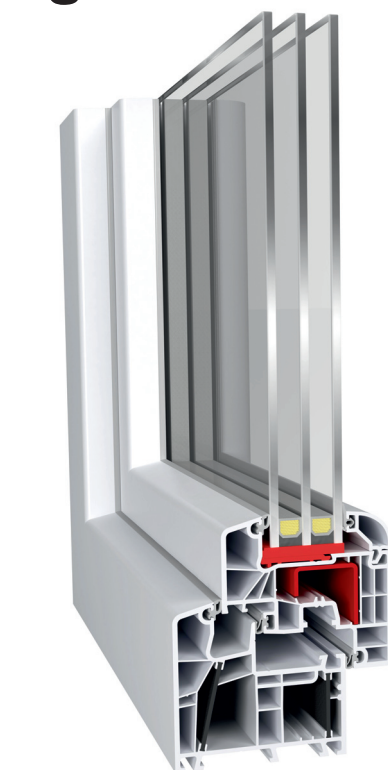
Der Fensterbauer erstellt die Systeme in Standardbauweise und versieht sie deshalb mit einer auf Maß geschnittenen Stahlarmierung.
